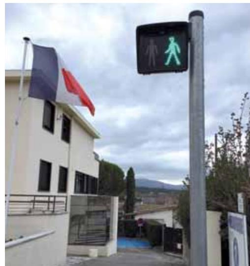
Un feu comportemental a été installé à proximité de l'école. Le principe est simple : si l'automobiliste ne roule pas à 30 km/h, le feu restera au rouge.
